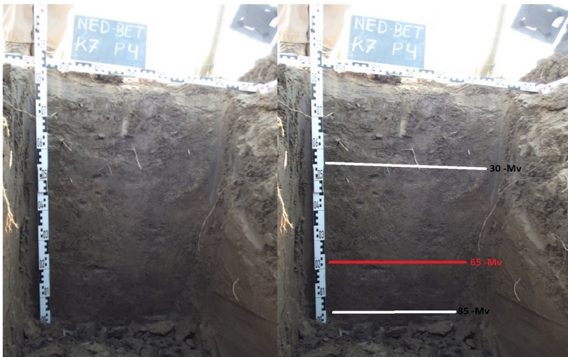
K7P4 - De bouwvoor loopt tot 30 cm, en tot 65 cm -mv zijn sporen van verstoring te zien, onder andere in de vorm van zandige humeuze vlekken. De bovenste 85 cm -mv van put 4 bestaat uit uiterst siltige klei. Onder de 85 cm -mv ligt sterk siltig zand.
